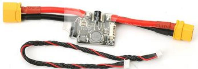
图2 飞控电源模块
